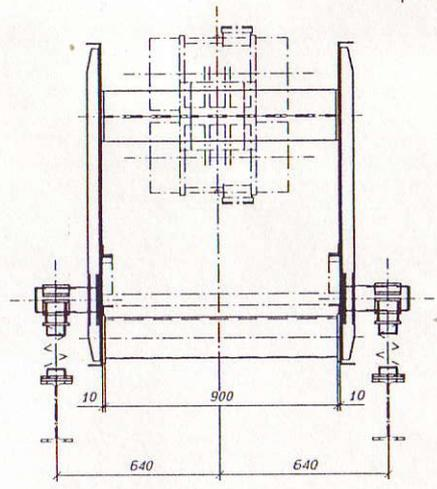
Antrieb durch Rüttlermotoren; Siebmaschine im eingefederten Zustand; Einfederung beträgt 30...40 mm; Neigung beträgt 5°; Für die exakte Dimensionierung der Unterstützungskonstruktion genügt eine statische Berechnung im Allgemeinen nicht. Es wird empfohlen, eine schwingungstechnische Berechnung durchzuführen.
